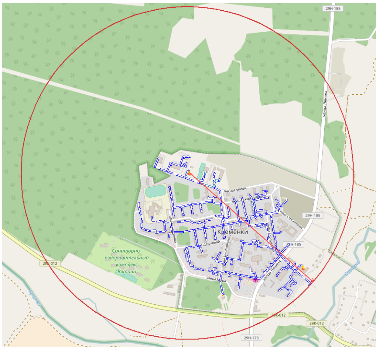
Рис.7 Существующая зона действия котельной
